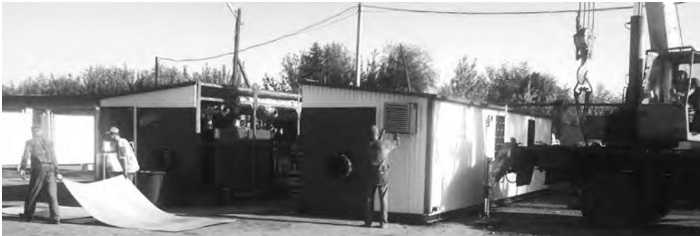
Торговый отдел завода «Газ-Сервис» готовит к отгрузке транспортабельную котельную установку ТКУ - 2 МВт, в составе двух блок-модулей на базе двух котлов Riello с горелками RS. Заказчик — ФКП «Завод имени Я. М. Свердлова», г. Дзержинск.
